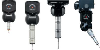
Cabeçotes motorizados que possibilitam a indexação de até 720 diferentes posições. Os modelos PH10M e PH10MQ permitem a conexão de sensores especiais como sensor de scanning, sensores ópticos, cabeçote laser e sensor de rugosidade.
