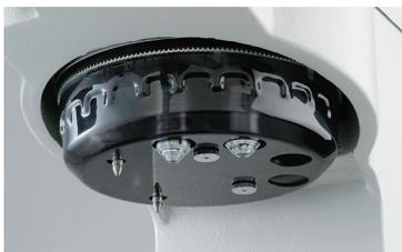
Torre motorizada. Até quatro objetivas e dois penetradores podem ser montados simultaneamente.
