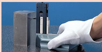
Marcar uma peça utilizando a base, um suporte e o bico traçador
