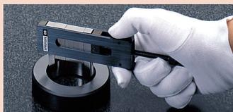
Verificar um diâmetro interno usando um par de bicos meia-cana e um suporte
