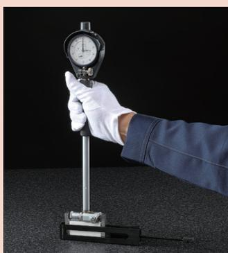
Configurar um Comparador de Diâmetro Interno utilizando um suporte junto com o par de bicos meia-cana tipo I utilizados como superfícies planas de contato.
