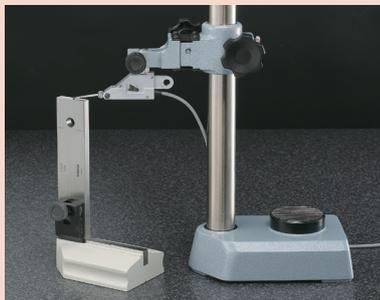
Zerando um relógio apalpador em uma pilha de blocos padrão longos acoplados à base pelo conector tipo D.
