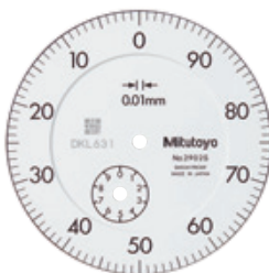
Modelo com leitura reversa, aplicável em medição de ressalto e profundidade.
