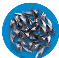
SCM440 VP-GDR ø 8,5 Velocidade: 32 m/min. Avanço: 0,24 mm/rot.
