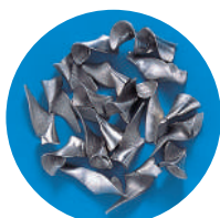
SUS304 EX-SUS-GDR ø 8,5 Velocidade: 18 m/min. Avanço: 0,2 mm/rot.
