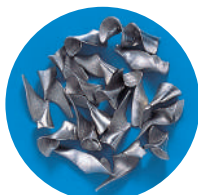
SUS304 EX-SUS-GDR ø 8,5 Velocidad: 18 m/min. Avance: 0,2 mm/rot.
