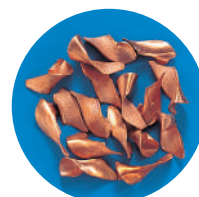
C1020 EX-SUS-GDR ø 8,5 Velocidade: 32 m/min. Avanço: 0,24 mm/rot.
